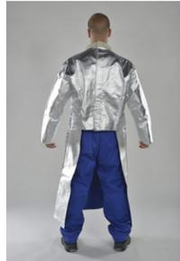
Tablier-manteau en tissu aluminisé AL600 500gr/m<sup>2</sup>, isolant en feutre carbone 300gr/m<sup>2</sup>, doublure coton Proban 340gr/m<sup>2</sup>, fermeture par auto-agrippant et boutons pression, couture fil Kevlar.
