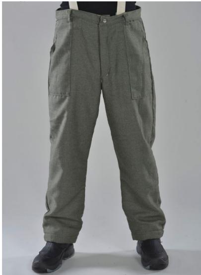
Pantalon en tissu Preox kevlar 400gr/m<sup>2</sup>, isolant en feutre carbone 300gr/m<sup>2</sup>, doublure coton Proban 340gr/m<sup>2</sup>, couture fil Kevlar.
